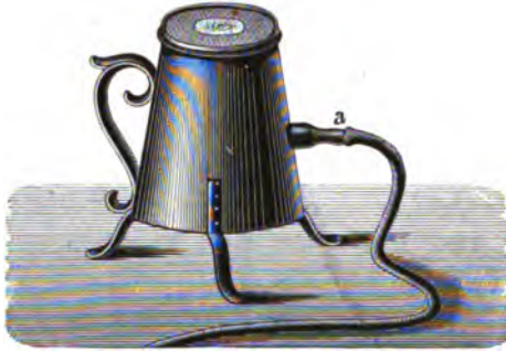
Die Mitte einer grossen Gasflamme besitzt niedere Temperatur.
